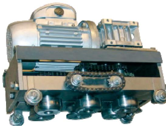
Фальцезакаточная электрическая машинка используется при закрытии двойного стоячего кровельного фальца. Машинка обладает уникальной конструкцией протягивающих и профилирующих роликов. Фальц закрывается за один проход. Работает машина на мотор-редукторе.
